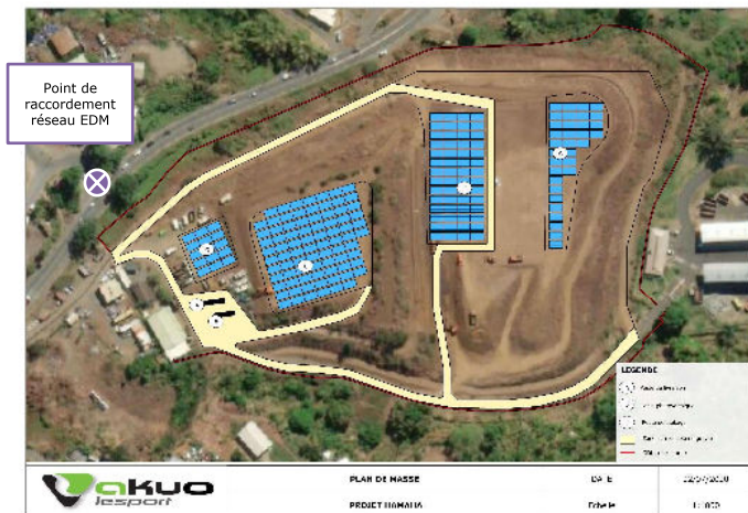
Figure 117 : Localisation du poste de raccordement pressenti sur la ligne HTA du réseau local nécessitant un raccordement souterrain depuis le PdL de la centrale photovoltaïque (localisation à confirmer, en attente du retour de la PRAC)
